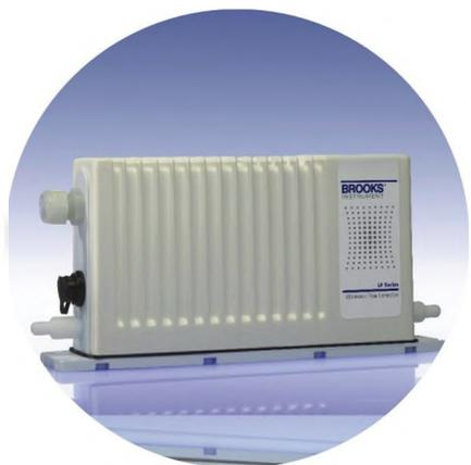
В серии LF200 используется запатентованный датчик, который позволяет добиться чрезвычайно высокой точности измерений. Даже при очень низкой скорости потока, например, 50 мл/мин, LF200 может управлять потоком с точностью +/- 0,5 мл/мин.
